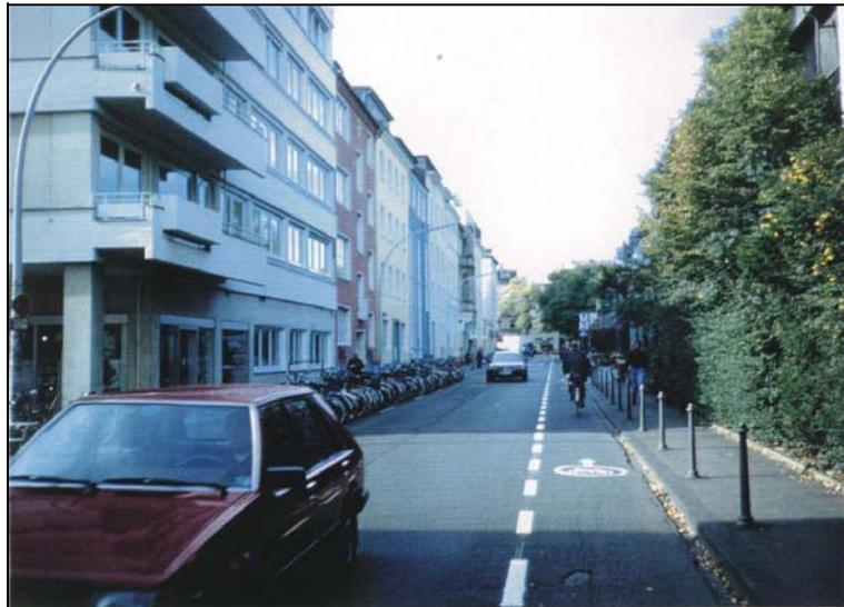
Bild 7-1: Schutzstreifen gegen Einbahnrichtung bei breiter Fahrgasse (Bonn)
