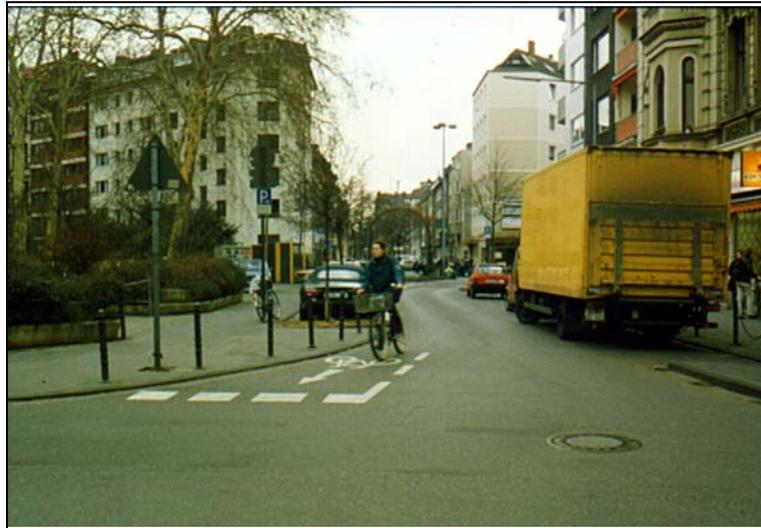
Bild 7-4: Markierung einer Ausfahrtschleuse mit Wartelinie für gegengerichteten Radverkehr an einem rechts-vor-links geregelten Knotenpunkt (Köln).
