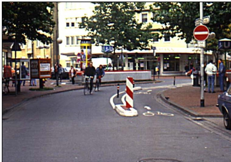
Bild 7-3: Bauliche Absicherung für gegengerichteten Radverkehr im Kurvenbereich durch Schwellen und Markierung (Hannover)
