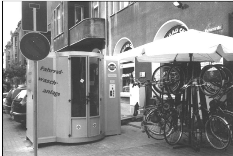
Bild 11-1 Automatische Fahrradwaschanlage (Cottbus)
