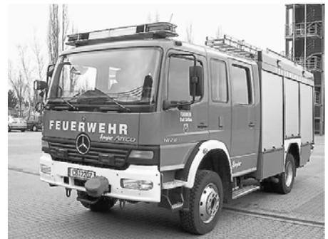
Hilfeleistungslöschgruppenfahrzeug HLF 20/24
