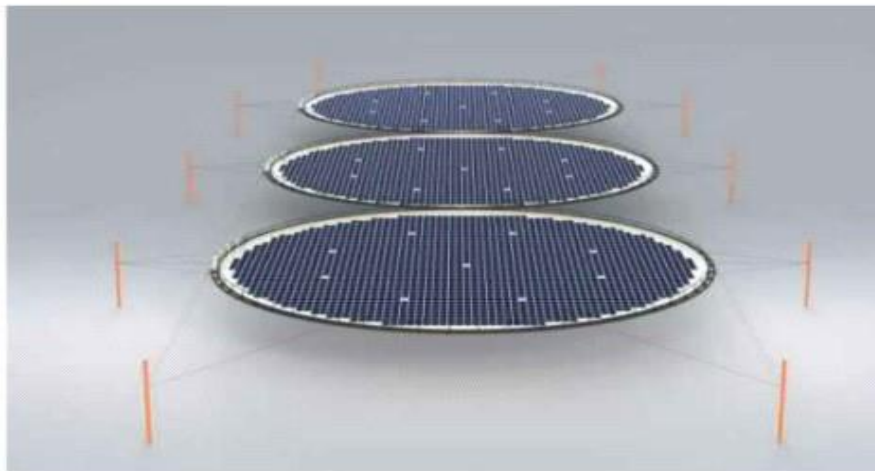
Abbildung 6: Unterkonstruktion - Schematischer Aufbau Verankerung Ringstruktur mittels Dalben | Quelle: Ocean Sunf
